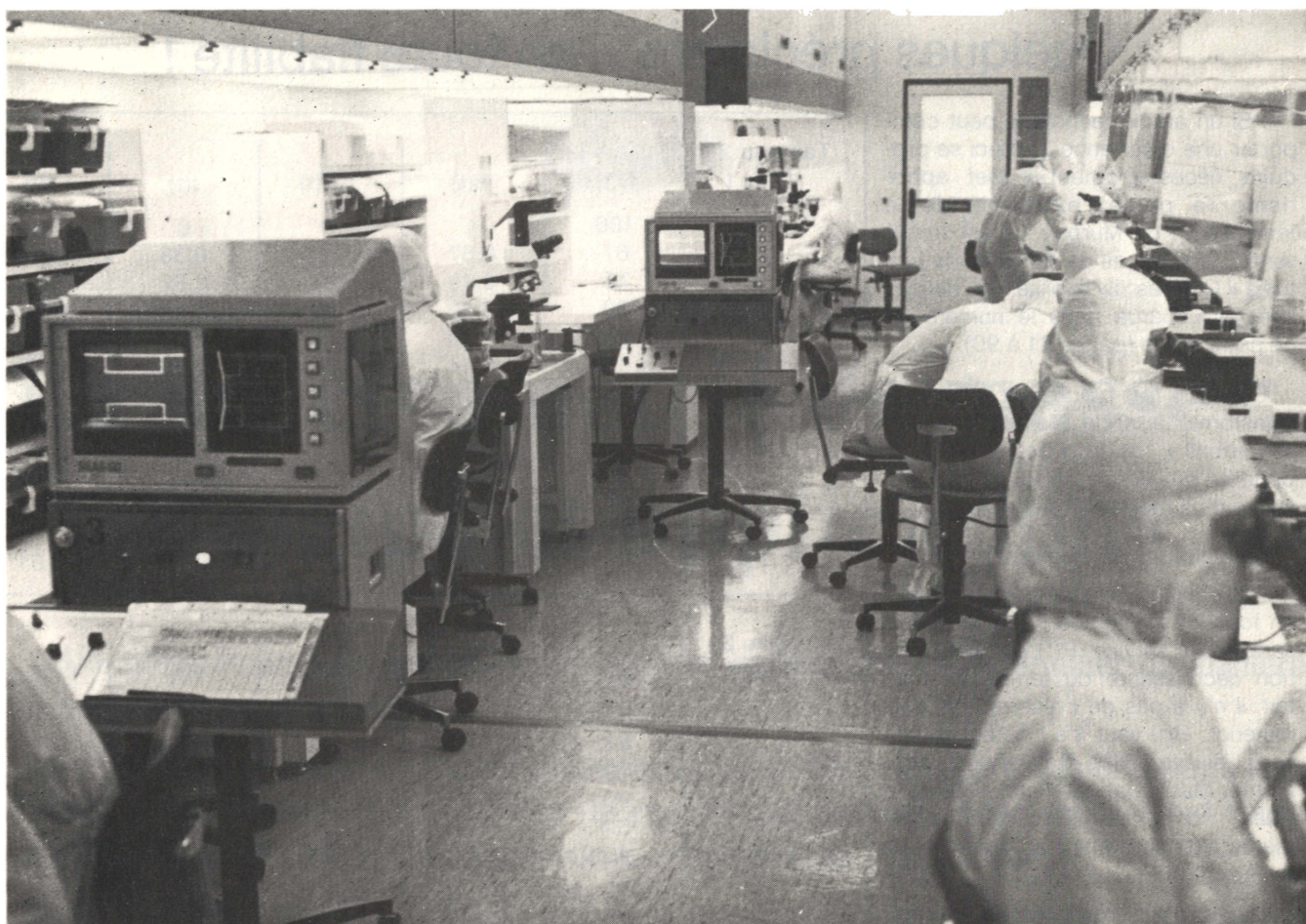
Vue d'une salle de contrôle par microscopie de « chips » LSI (doc. Siemens).
