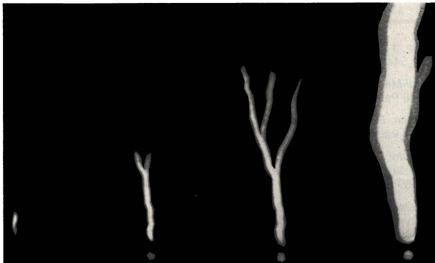
Fig. 24. – Phases de développement du streamer ascendant à la pointe du paratonnerre ionisant électrique Corona. La lecture se fait de gauche à droite. Le point lumineux situé en bas des clichés correspond au fonctionnement de l'éclateur du paratonnerre Corona (vitesse de prises de vues : 20 millions d'images par seconde – doc. Héliita).
